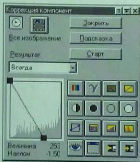
Воспользуемся командой «Коррекция компонент», которая позволяет настраивать переходную характеристику, представленную в графическом виде, с помощью мыши. Просто передвинем черные квадратики на передаточной характеристике в положение, указанное на рисунке. Обратите внимание, что для каждой текущей конфигурации фильтра программа строит гистограмму изображения, которое получится в результате применения фильтра.
