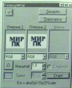
Теперь настала очередь команды «Калькулятор». Мы воспользуемся ею несколько раз подряд. Обратите внимание на то, чтобы при выполнении всех операций изображения были одинакового размера. Выполним операцию «Разность» над двумя размытыми изображениями, сдвинутыми относительно исходного. Эта ползунковая операция вычисляет модуль разности яркостей двух изображений в каждой точке.
